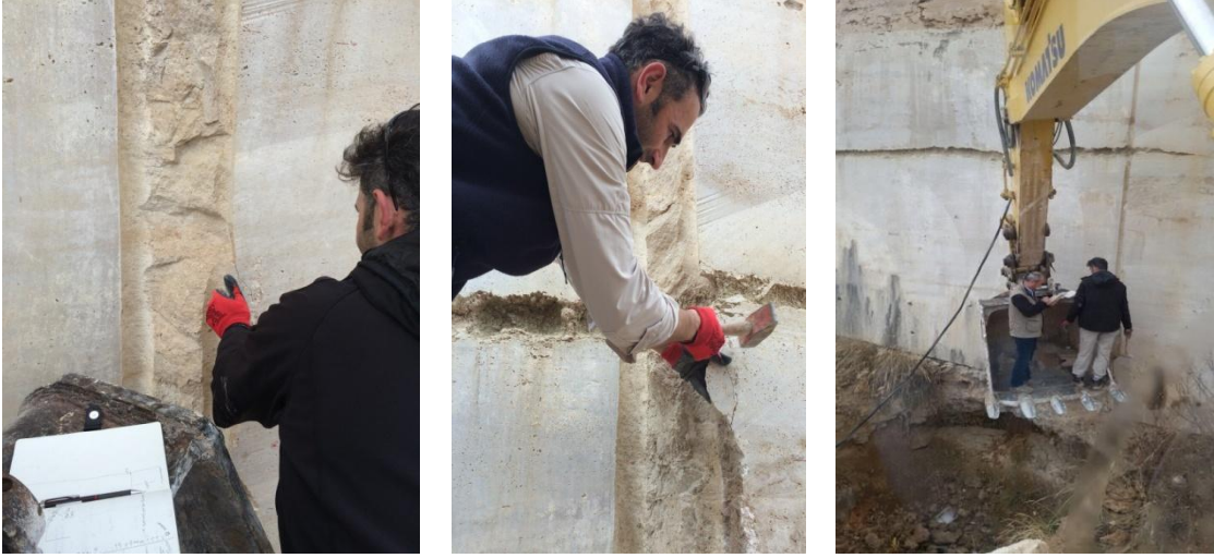
Şekil 13. Güvencem Mermer ve Madencilik İşletmesinin traverten ocağında iş makinesi yardımıyla yapılan örnekleme.
