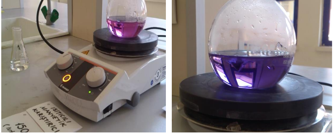
Şekil 15. \text{CoCl}_4^{-2} - \text{Co}(\text{H}_2\text{O})_6^{+2} dengesi etkinliği dördüncü aşama (ikinci ısıtma işlemi öncesi ve sonrası)
