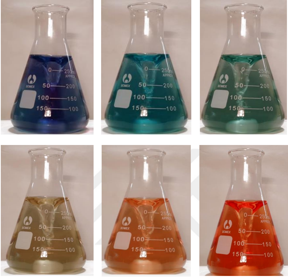
Şekil 8. \text{KMnO}_4 renk döngüsü TGA etkinliğinde oluşan renk değişimleri
