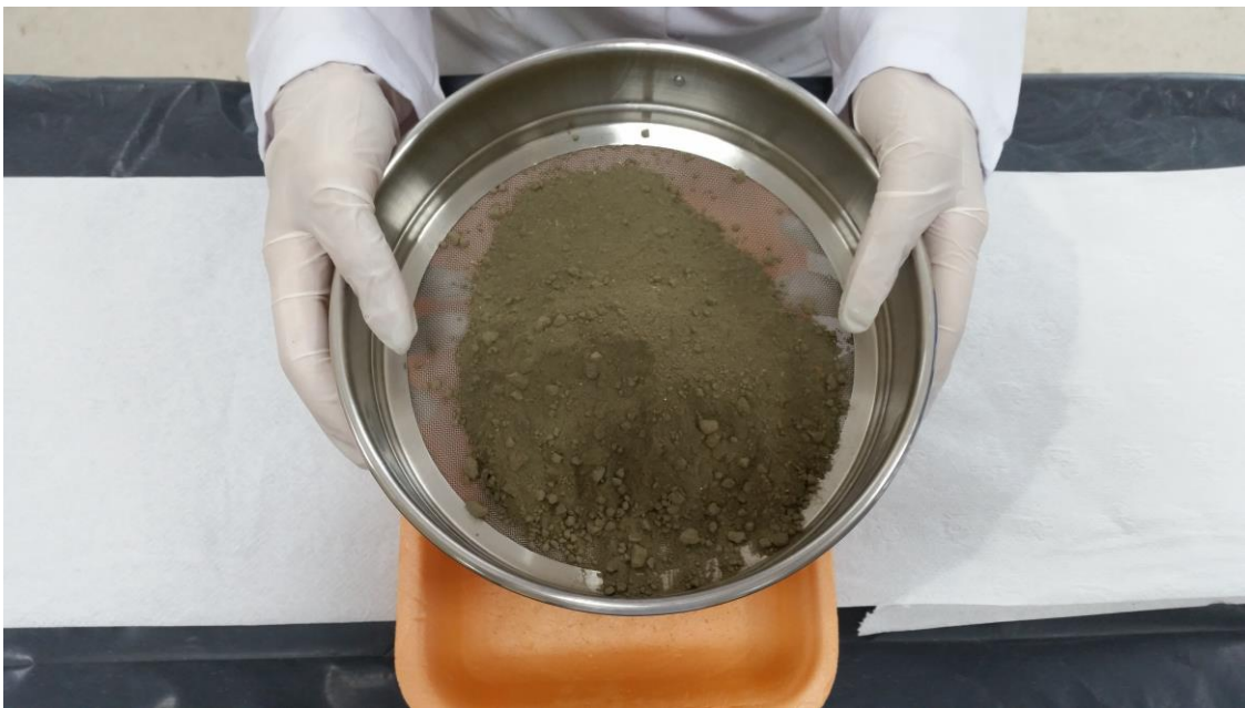
Şekil 21. Elekten (37 µm) geçirilen sediment örnekleri
