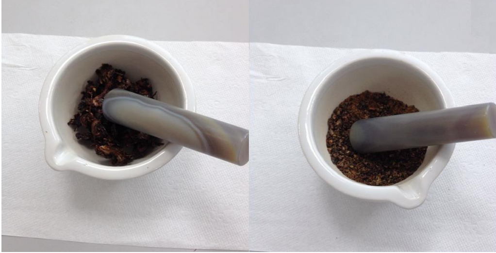
Şekil 26. Midye örneklerinin yumuşak dokularının agatta öğütülmesi
