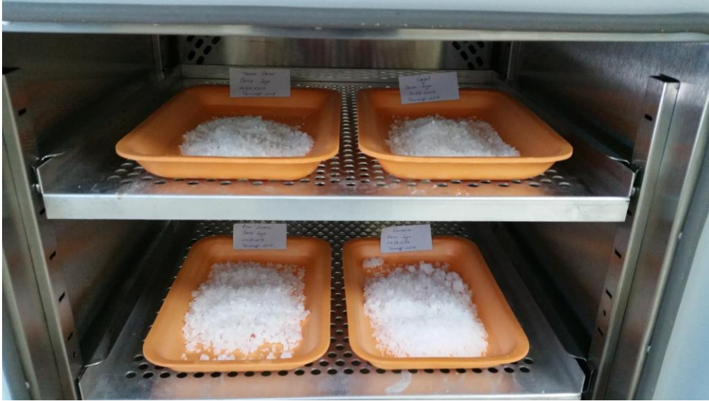
Şekil 17. Elde edilen deniz suyu tortularının etüvde kurutulması
