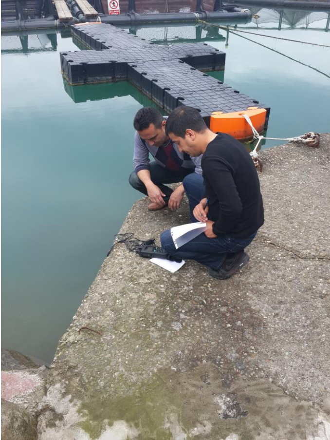
Şekil 11. YSI marka prob (sonda) ile deniz suyunun kalite parametrelerinin ölçümü (T3 istasyonu, Şubat 2014)
