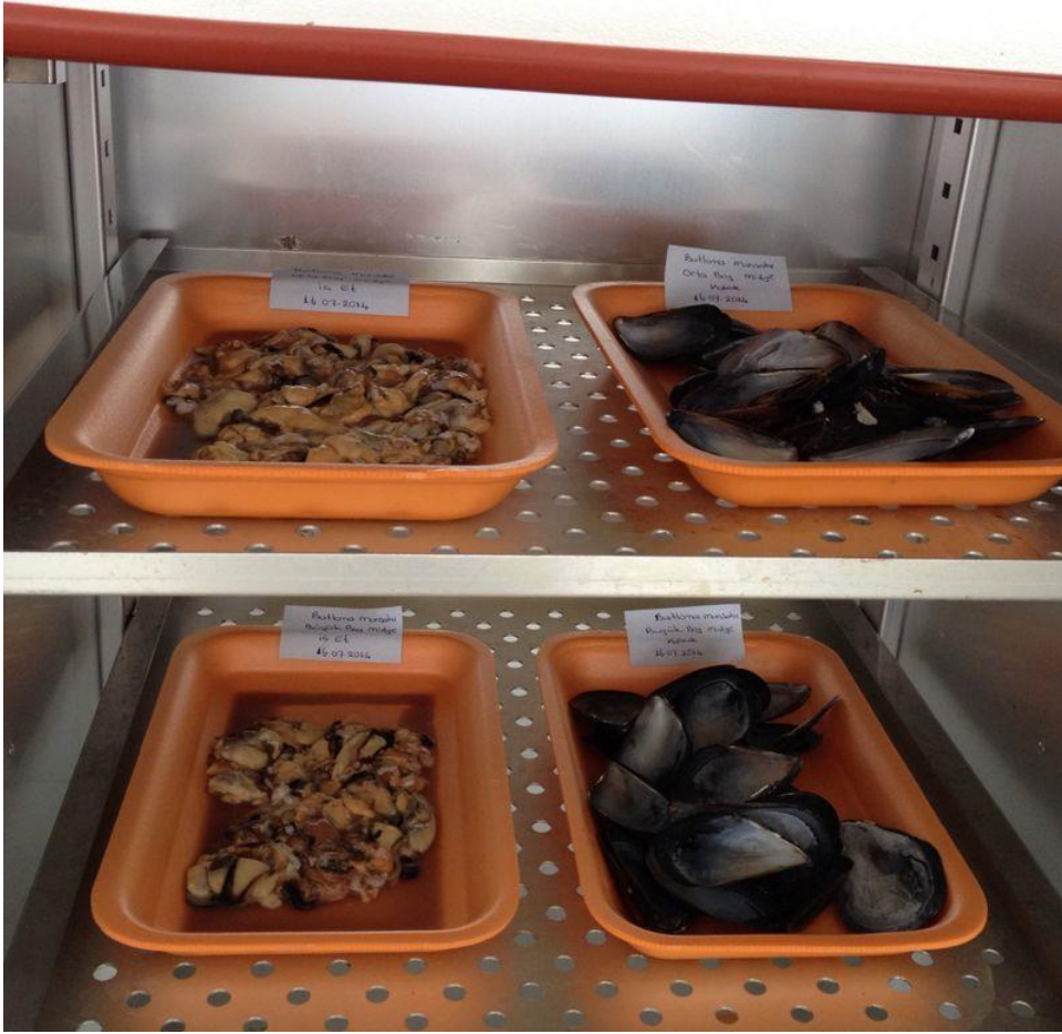
Şekil 25. Midye örneklerinde yumuşak doku ve kabukların etüvde 105 °C' de kurutulması
