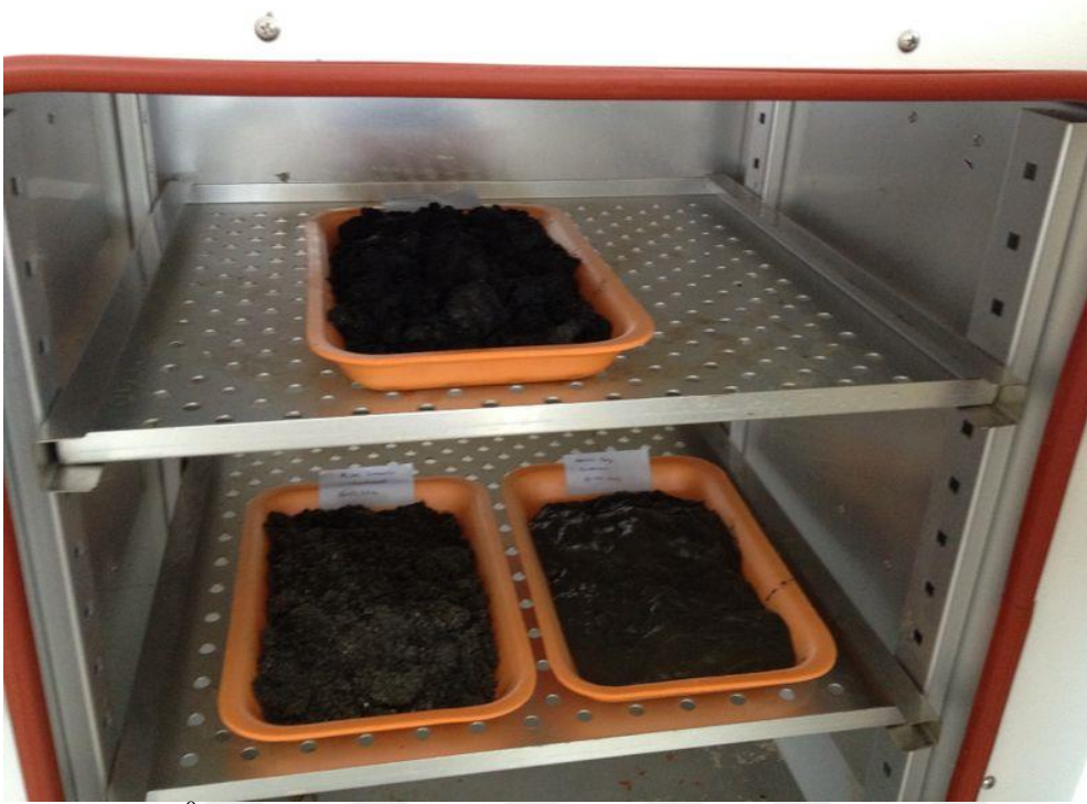
Şekil 20. 85 °C'de etüvde kurutulan sediment örnekleri
