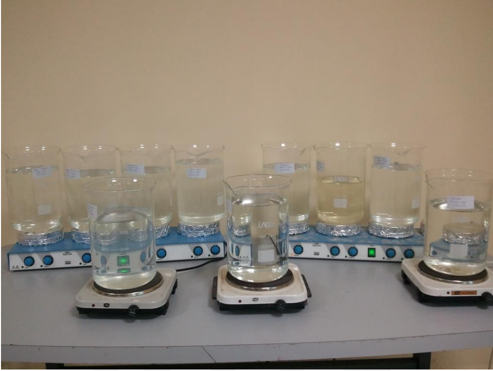
Şekil 15. Deniz suyu örneklerinin elektrikli ısıtıcılar üzerinde buharlaştırılması
