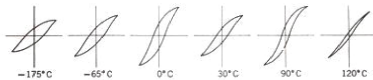
Şekil 11. BaTiO 3 histerisiz eğrisinin farklı sıcaklıklardaki durumu
