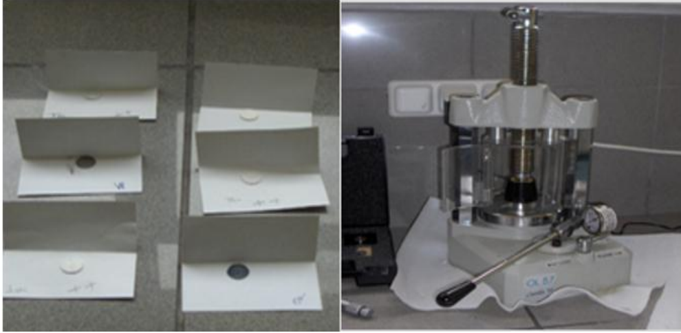
Őekil 12. (a) 1,3 cm apında pelletler (b) Hidrolik pres aleti
