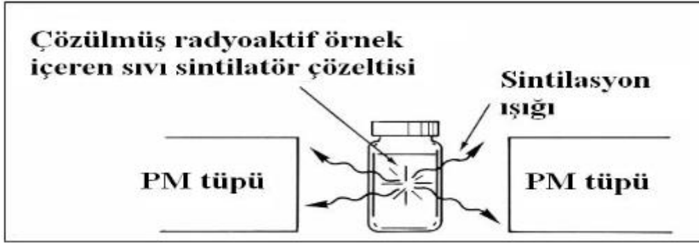
Şekil 22. Vial içerisindeki örneğin sintilasyon mekanizması
