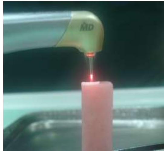
Resim 3. Er;Cr;YSGG lazer ile pürüzlendirme işleminin görüntüsü.
