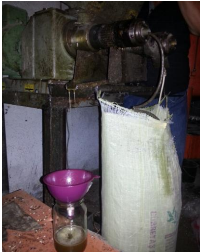
Şekil 2. Aspir, Dinçer çeşidi tohumundan yağ çıkarmada kullanılan vidalı pres Figure 2. The screw press used to extract oil from the seed of safflower, Dincer species
