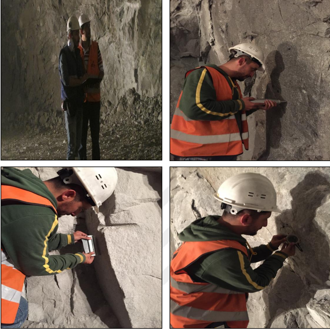
Şekil 7. Tünel ayna ve duvarında yapılan süreksizlik ölçümlerine ait fotoğraflar
