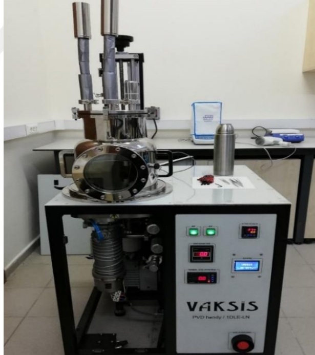
Şekil 27. Ag kaplamasında kullanılmış soğuk altlık tekniği cihazı.
