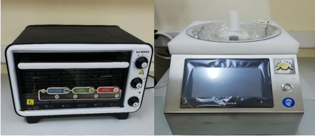
Şekil 25. Kullanılan Sol-gel döndürme kaplama ve tavlama fırın cihazlarının fotoğrafları.
