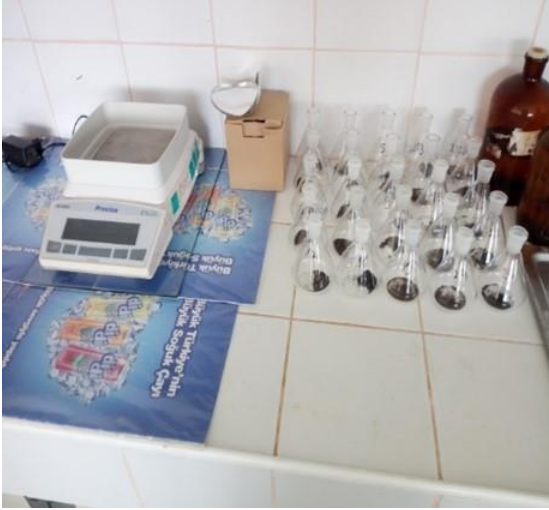
Şekil 8. Vermikompost numunelerinin analize hazırlanması ve tartımı
