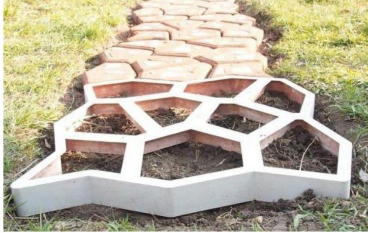
Şekil 1. Mimari ve estetik amaçlı üretilen parke kalıbı
