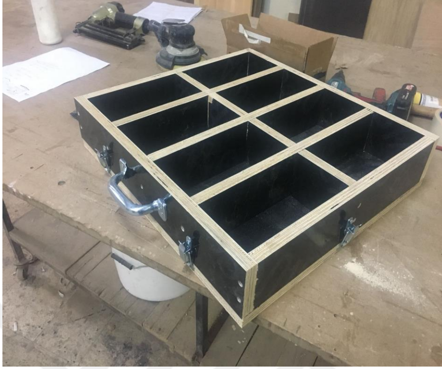
Şekil 6. Parkelerin üretiminde kullanılan kalıbın görüntüsü
