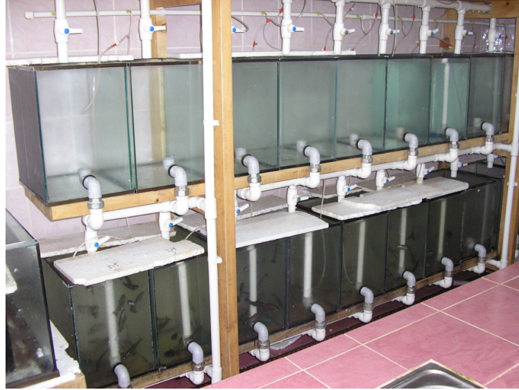
Şekil 3. Toksikolojik testlerde kullanılan 40 litrelik akvaryum sistemleri
