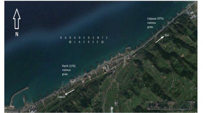
Şekil 3. Çalışma alanından T-mahmuz görüntüleri (Kıyıcık ve Eskipazar Grubu-Hasar tespiti için)
