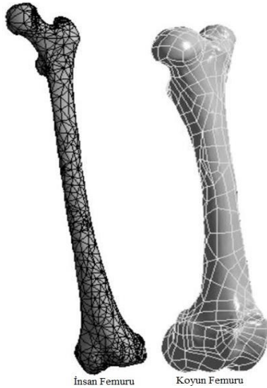
Şekil 2. Üç boyutlu modelin ağ yapısı. Figure 2. Mesh structure of the three-dimensional model.
