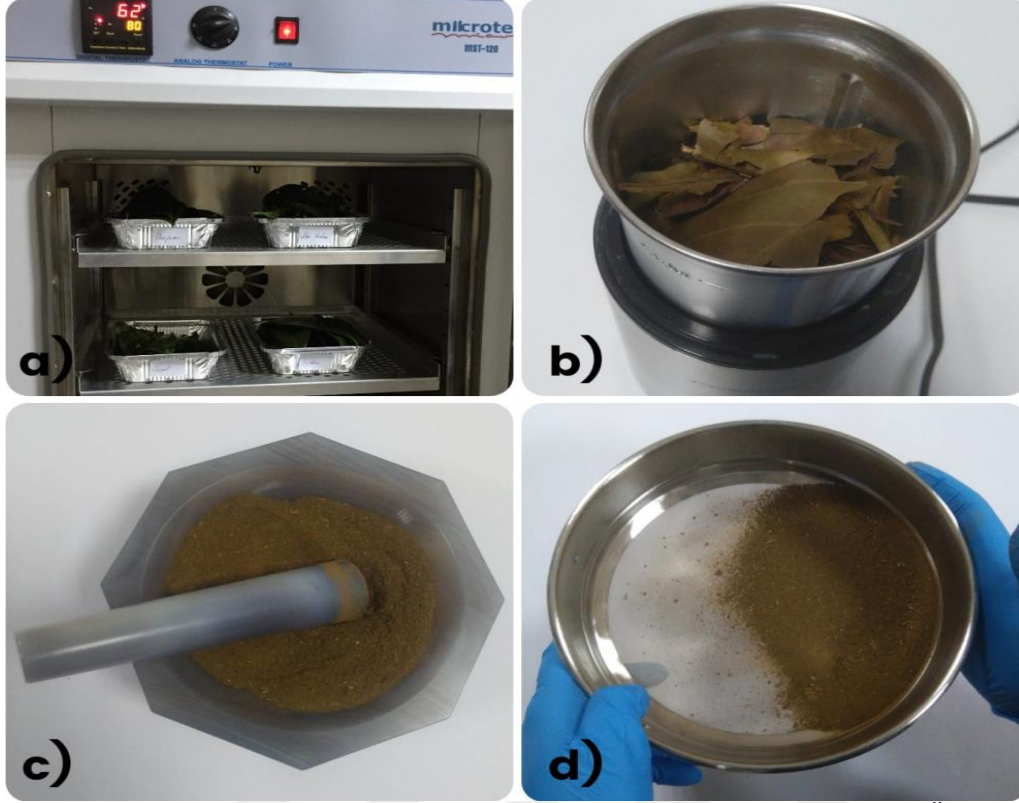
Şekil 10. Karayemiş yaprak örneklerinin laboratuvarında hazırlanması a) Örneklerin etüvde kurutulması b) Örneklerin öğütücüde öğütülmesi c) Örneklerin havanda karıştırılması d) Örneklerin 63 µm' lik elekten elenmesi.
