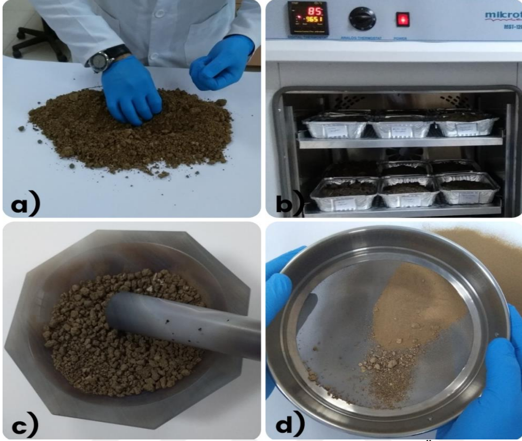
Şekil 8. Toprak örneklerinin laboratuvarda hazırlanması a) Örneklerin etüvde kurutulması b) Örneklerin öğütücüde öğütülmesi c) Örneklerin havanda karıştırılması d) Örneklerin 63 µm' lik elekten elenmesi.
