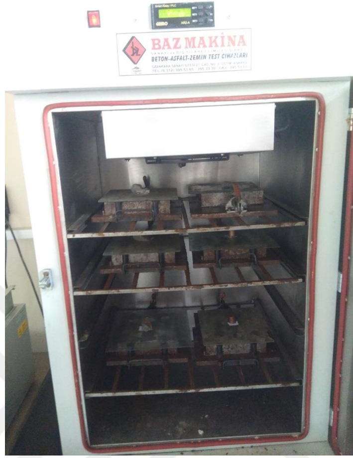
Şekil 7. Harç numunelerinin hazırlanışından itibaren 24 saat bekletildiği iklimlendirme kabini
