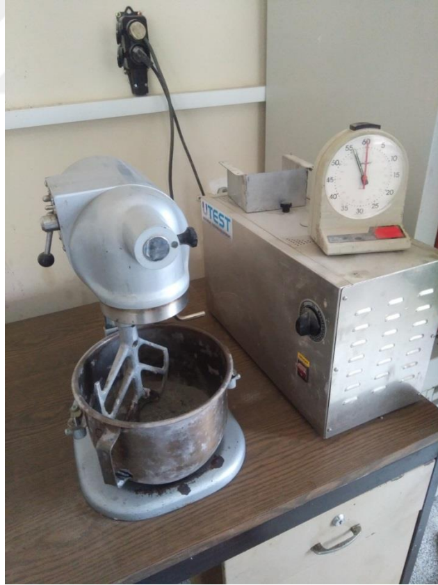
Şekil 5. Harç numunesinin mikserde karıştırma görüntüsü
