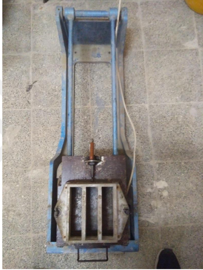
Şekil 6. Sarsma tablası ile prizmatik numune kalıbı görüntüsü
