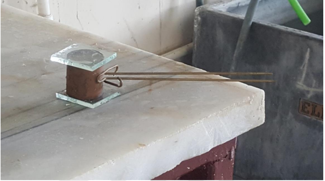
Şekil 11. Hacim sabitliği ölçümünde kullanılan Le Chatelier halkaları
