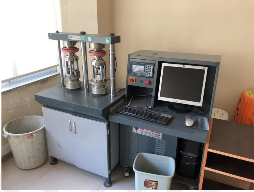
Şekil 9. 2, 7 ve 28 günlük eğilme ve basınç deneylerinin yapıldığı cihaz
