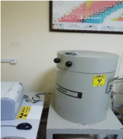
Şekil 1. HPGe dedektörüne ait zırhlı numune odasının yandan (sol panel) ve üstten (sağ panel) görünümü.
